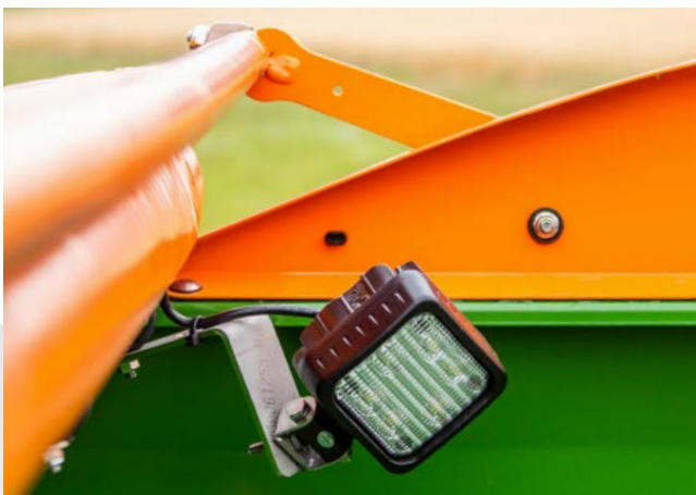
Éclairage de l'intérieur de la trémie
