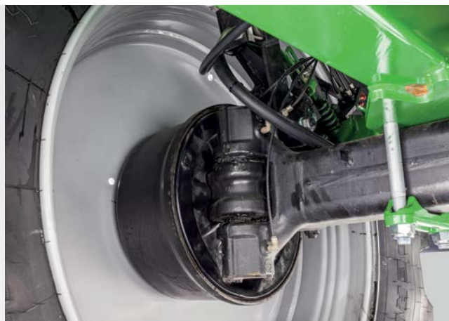
Régulation de la force de freinage par le système de freinage électronique (EBS)
