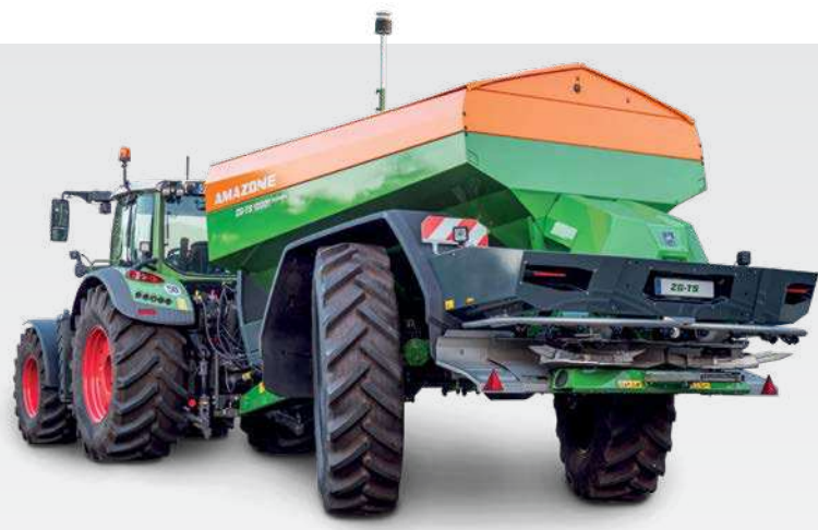
Essieu directeur avec un angle de braquage jusqu'à 28°
