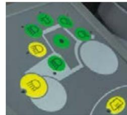
■ L'éclairage est facile à régler et à ajuster grâce à son agencement simple et clair. Le système intelligent à une seule touche permet d'allumer facilement et rapidement tous les phares de travail réglés au préalable en touchant tout simplement une touche située sur le panneau de commande du clavier.
