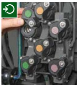
□ Les raccords à accouplement sous pression des deux côtés facilitent nettement le montage et le démontage des outils. Les volets à fermeture automatique protègent le tracteur contre la contamination et permettent de connecter un flexible hydraulique d'une seule main.
