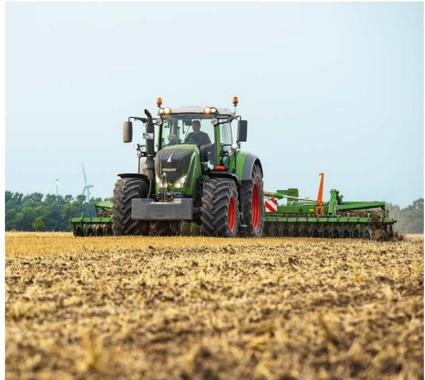
Le tracteur règle automatiquement la limite de charge et ajuste le régime moteur et le rapport de transmission. De cette façon, le moteur et la transmission sont parfaitement coordonnés, ce qui se traduit par une sobriété exemplaire.
