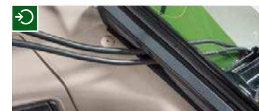
■ Fendt propose une solution intelligente pour les câbles en provenance de l'arrière du tracteur qui pénètrent dans la cabine. Les câbles peuvent être acheminés par le passe-câbles, quelle que soit leur section. Le conducteur peut fermer la vitre arrière pour empêcher la poussière, les impuretés, l'eau et le bruit de pénétrer à l'intérieur.
