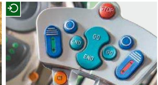
Grâce au système de séquençage de fourrière Variotronic<sup>®</sup> les utilisateurs peuvent créer des séquences de travail en bout de champ, en conduisant ou à l'arrêt, et les mémoriser. Les réglages du moteur, de transmission, des distributeurs hydrauliques et du relevage avant/arrière, de la prise de force avant/arrière et du système de guidage automatique ainsi que de leurs fonctions individuelles, sont effectués via le système de séquençage de fourrière et peuvent être rappelés facilement.
