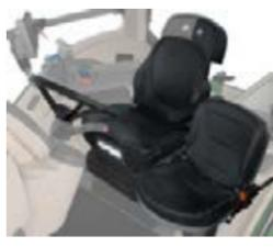
□ Le siège Evolution active Dualmotion super confort à suspension pneumatique est le modèle haut de gamme. Le conducteur profite du confort offert par la suspension active supplémentaire. Le siège peut être revêtu de tissu noir ou de cuir souple assorti au cuir du volant.
