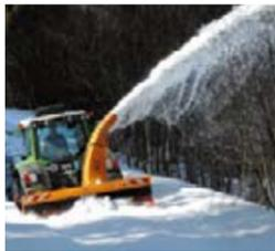
□ Le Fendt 800 Vario est idéal pour les opérations en marche arrière grâce au poste de conduite inversé qui pivote de 180°.
