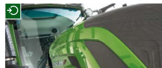
□ Le tracteur Fendt est équipé de vitre collées. Outre un avantage véritable pour l'utilisateur en termes de visibilité, cela permet d'éviter les grincements et constitue une étanchéité à toute épreuve. Fini les bruits de grincement et les fuites. Le pare-brise est également chauffé.
