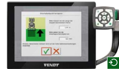
Lorsque vous utilisez des pulvérisateurs, des distributeurs d'engrais ou des semoirs compatibles ISOBUS, la fonction SectionControl vous permet désormais de gérer jusqu'à 36 tronçons.
