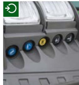
■ La commande sur le garde-boue arrière, vous permet d'actionner le relevage arrière, la prise de force et le distributeur depuis le sol. En commandant la prise de force arrière depuis le sol, il est possible d'atteindre automatiquement un régime préétabli. Les étapes inutiles sont ainsi éliminées, par exemple lors du remplissage de la tonne à lisier.
