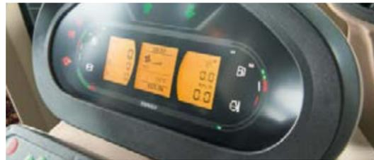
■ L'éclairage intérieur du Fendt 800 Vario est conçu parfaitement pour illuminer les zones importantes de la cabine. De jour comme de nuit, les principaux éléments de commande sont agréablement rétroéclairés. L'intensité du rétroéclairage est contrôlée automatiquement à partir du terminal Vario par un capteur en fonction des conditions environnantes.
