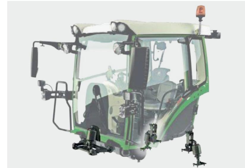
□ La suspension pneumatique de cabine supprime les oscillations dans l'habitacle. La différence de hauteur entre les éléments de suspension de la cabine X5 empêche en outre le tangage, assurant ainsi un maximum de confort.
