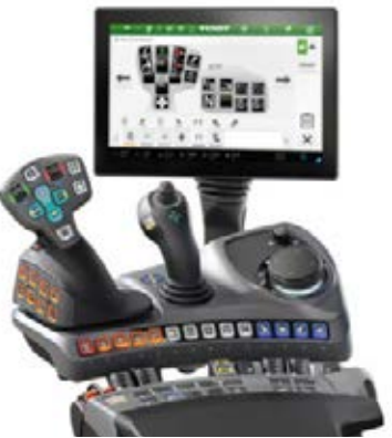
Power+ Setting 2 - 3L-joystick - 1 paar wipschakelaars (lineaire module) om de hydrauliekventielen te bedienen
