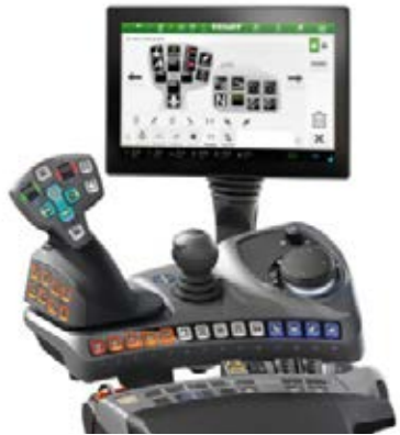
Power Setting 2 - Kruishendel - Geen wipschakelaars (lineaire module) om de hydrauliekventielen te bedienen
