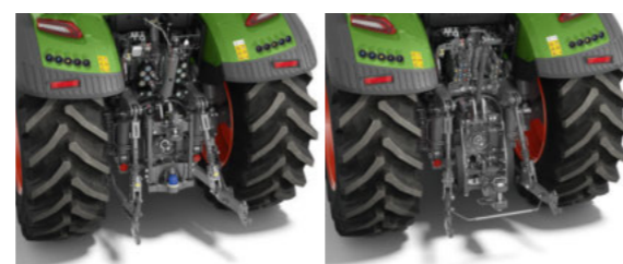
Relevage arrière avec crochets et stabilisateurs latéraux (EU)
