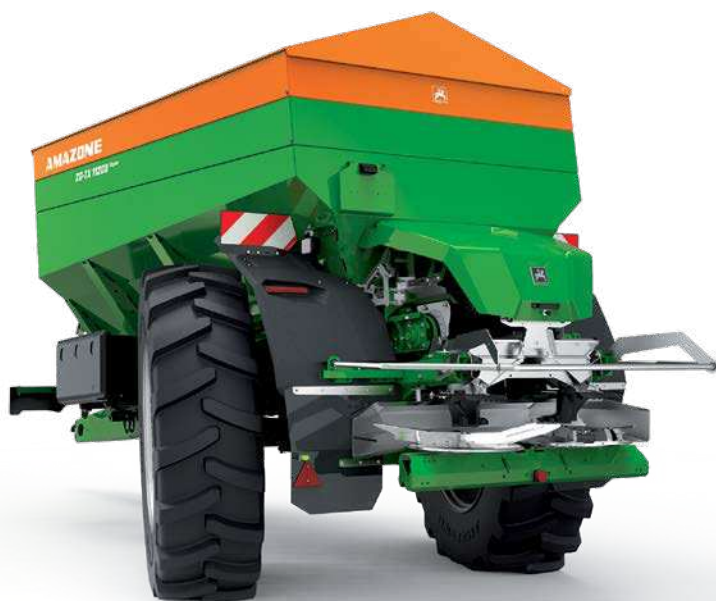
Gestuurde as met stuuruitslag tot 20°
