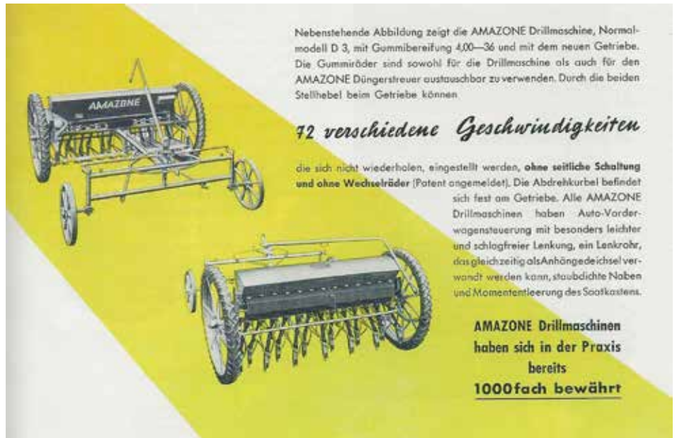
De 4.00 – 36 rubberwielen van de D3 zaaimachine konden ook worden gemonteerd op de Amazone-schotelstrooiers voor het strooien van kunstmest.
