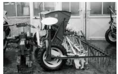
In 1966 bracht men de eerste mechanische zaai-bedcombinatie op de markt: de RE-schudeg met opgebouwde D4 zaaimachine.
