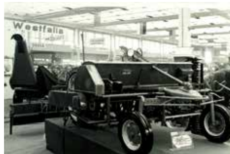
Hilaire Van der Haeghe was tot begin de jaren 1960 importeur van Allis Chalmers-trekkers. Hier een Amazone-zaaimachine opgebouwd tussen de voor- en achterwielen van een Allis Chalmers G-werktuigendrager.
