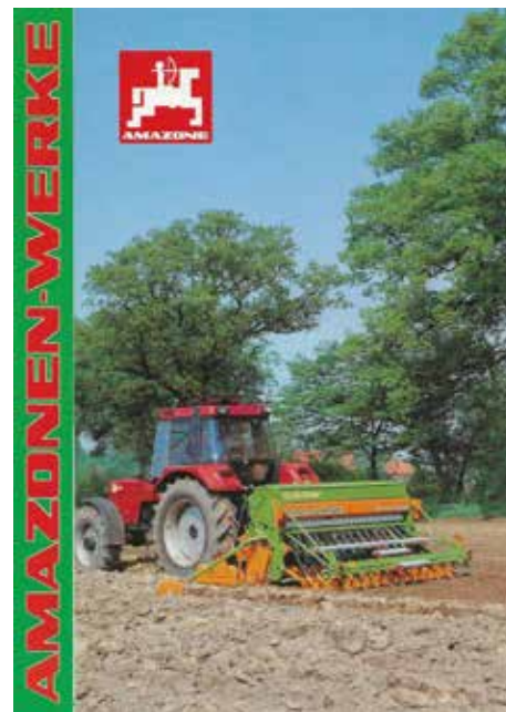
Met de introductie van de RPD DrillStar in 1988 bood Amazone de eerste bandenpakkerrol aan als alternatief voor de kooirol en de packerwals. De bandenpakkerrol zorgde voor een strooksgewijze verdichting van de grond.
